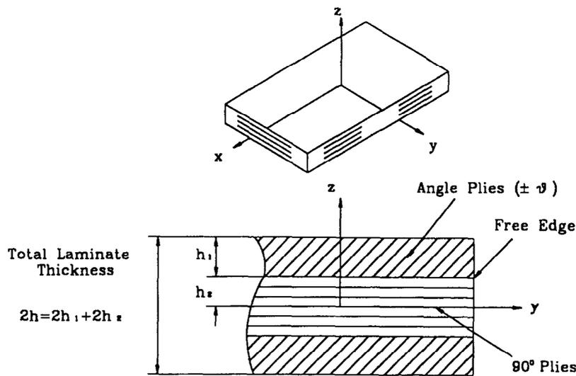
Figure 1 Delamination coupon<sup>6</sup>
