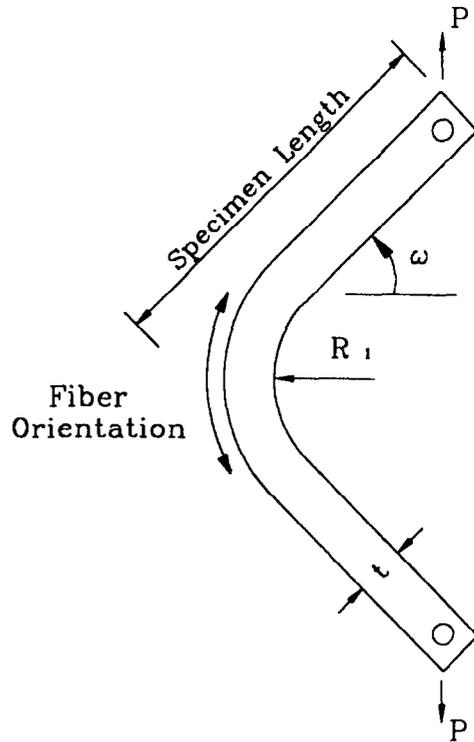
Figure 6 L-beam specimen<sup>15</sup>
